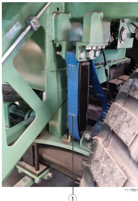
Fig. 176: Contrôler l'usure de la courroie de sécurité
