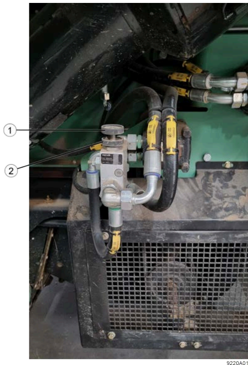
Fig. 150: Régler la vitesse du ventilateur de nettoyage
