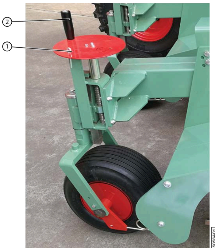
Fig. 131: Régler la hauteur du pick-up
