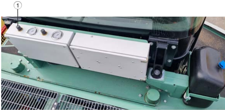
Fig. 142: Régler la pression des coussins d'air des rouleaux écraseurs
