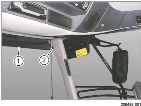
Fig. 105: Modifier le pare-soleil enroulable
