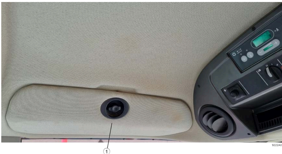
Fig. 51: Compartiment de toit dans la cabine
