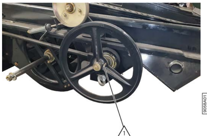
Fig. 206: Lubrifier l'axe excentrique
