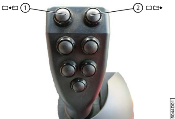
Fig. 126: Déplacer le pick-up droit avec le joystick
